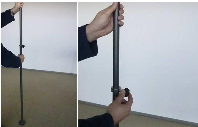
4. Stecken Sie den unteren Teil der Teleskopstütze in den Fuß und drehen ihn um 90 Grad nach links oder rechts. Die Teleskopstütze wird durch die Feder gesichert. Anschließend drehen sie das Drehrad an der Teleskopstütze bis Sie einen Widerstand spüren.
