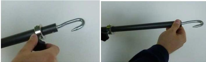
2. Lockern sie das Drehrad und Schieben den oberen Teil der Teleskopstütze um ca. 0,7-1m heraus.
