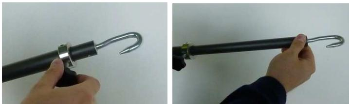
7. Lockern sie das Drehrad und Schieben den oberen Teil der Teleskopstütze um ca. 0,7-1m heraus.
