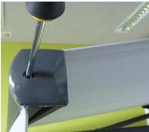
3. Lösen Sie die Schrauben der Endkappen auf beiden Seiten und demontieren diese durch Herausschieben.
